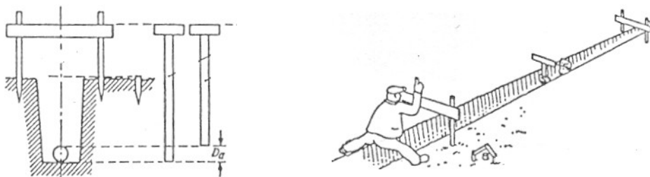
Σχήμα 1. Έλεγχος βάθους τοποθέτησης σωλήνων
